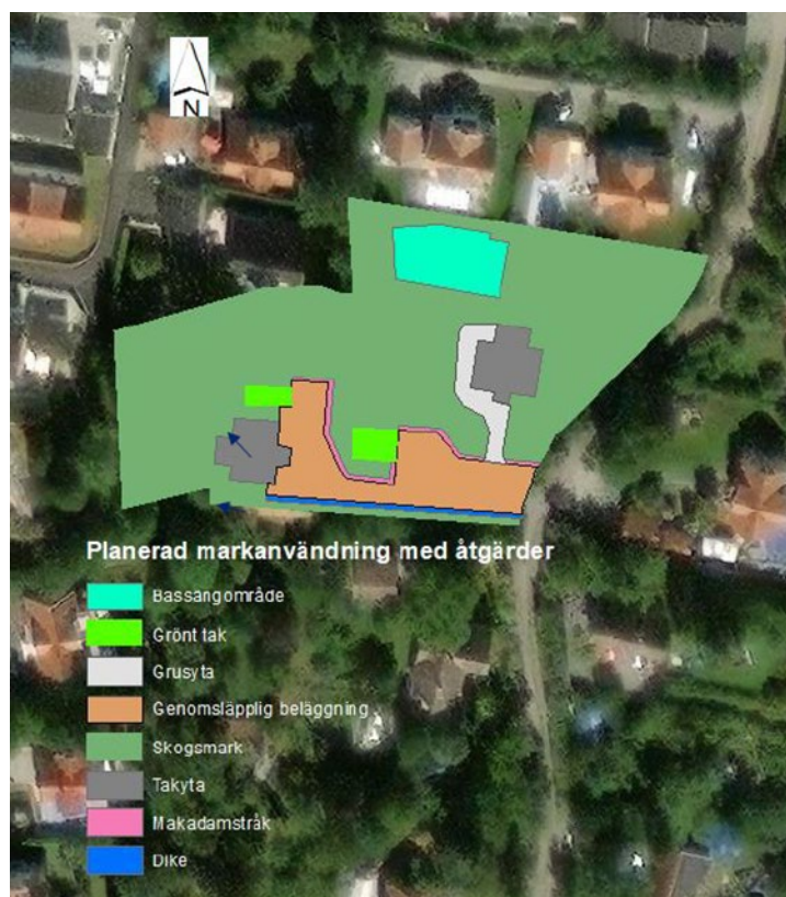
Schematisk placering av föreslagna åtgärder inom planområdet. Takvatten från det planerade bostadshuset föreslås ledas yligt till omgivande mark och redovisas med blåa pilar.
